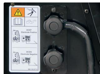
Il facile accesso ai morsetti di uscita consente di **cambiare polarità in modo pratico** quando si passa dalla modalità di saldatura con fili animati o pieni.
