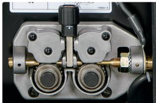
**Dispositif d'entraînement du fil robuste en aluminium moulé** incorporant un galet à gorge interchangeable rapidement, et un bras de pression sur ressort avec vis de réglage étalonnée.
