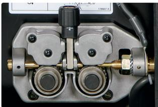
**El sistema de arrastre de aluminio fundido** incorpora rodillos de cambio rápido de ranura doble y tensores con rueda de ajuste, todo diseñado para un ajuste rápido y preciso.
