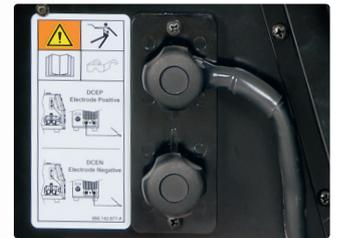
El sencillo acceso a los terminales de salida permite un **rápido cambio de polaridad**, cuando pasamos de utilizar hilo sólido a tubular.
